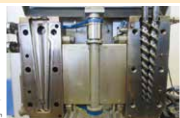
2軸のスクリューでセルロースナノファイバーを分散
