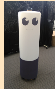
図3. 現実空間を移動する1.4mの自律移動ロボットのデザイン
