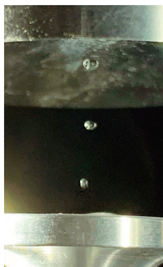
超音波により浮遊させた直径1mm程度の液滴
