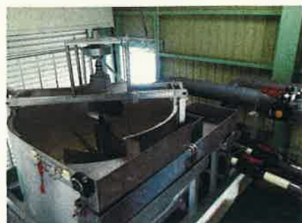
実証製作したたらい型水車
