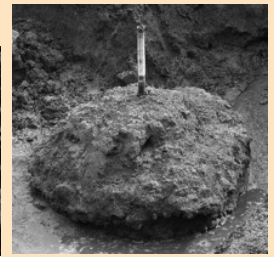
極超微粒子セメントの顕微鏡写真 浸透固化工法の出来高 (佐賀県唐津市における現場試験)
