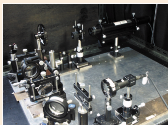
マイクロ工具の振れ測定光学系
