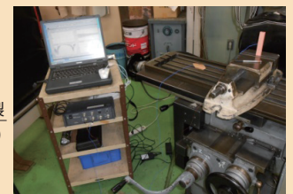
FFTアナライザーによる焼結材料の振動解析 (環境配慮型製品向けの焼結部品の振動解析)
