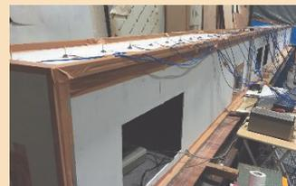
模型トンネルを用いて火災実験を行い、煙の流動について調べています。
