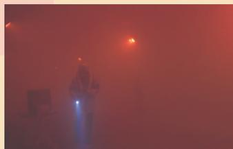
避難者の挙動解析のため、模擬した煙を用いて実大トンネルにて避難実験を行っています。本テーマは海外でも注目されており、積極的に海外との交流を行っています。
