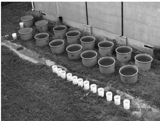
模擬生態系(水槽内)への重金属の影響を評価する実験 奥の大きな水槽は300L容量
