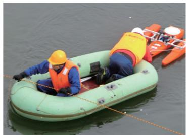
川の流れを3次元で計測している様子。
