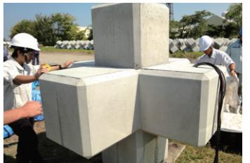
フライアッシュを混和したコンクリートを用いて製作された護岸ブロックの計測。
