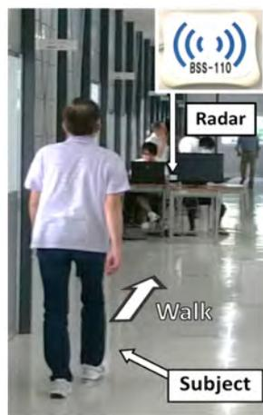
ドップラーレーダーは電磁波の反射を測定することで速度変化を測定できる機器です。今回は、ドップラーレーダーを用いて簡易で低コスト、非接触で計測できる健康チェックシステムの実現を目的に射水市在住の高齢者を対象に実験を行い、①運動計測パラメーター解析及び認知症リスク評価への応用、②歩行計測による腰椎圧迫骨折の判断システムの開発の2つに取り組みました。
