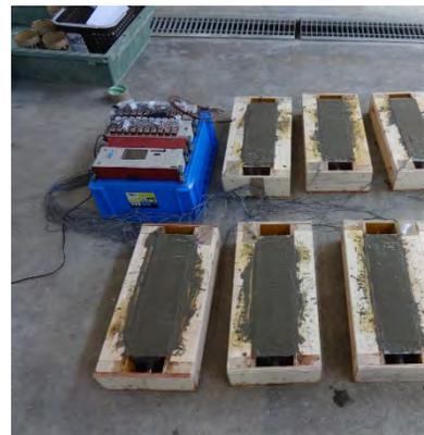
打設直後の鉄筋入り角柱供試体
