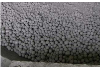
写真-1 造粒物の製造状況
