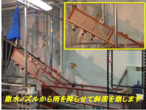
人工降雨による斜面崩壊実験例
